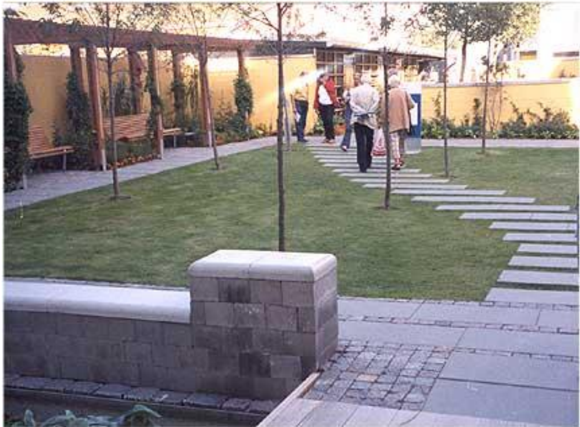
Foto 3: Elamumess Bo01 „City of Tomorrow“ kasutatud lahendused. Vuugitud kivi- ja plaatsillutised sademevee imendumiseks, madala põõsastikuga haljastatud alad ja hooldusenergiat mittenõudvad ronitaimed. (Foto: Anne Beer)
