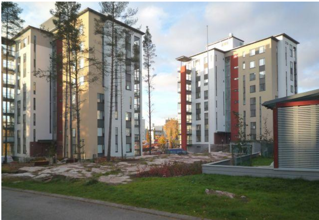
Foto 5: Espoo kogemused. Ehituse käigus säilitatavad puud on ehitustehnoloogiliselt olnud keerukas, kuid täiesti täidetav ülesanne. Sademevee imendumiseks kasutatud loodusliku kivi plaadistust on oskuslikult rikastatud madalate hooldusenergiat vähenõudvate põõsastega.
